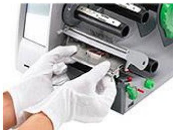
Le bouton vert permet d'ajuster le défilement des étiquettes.
