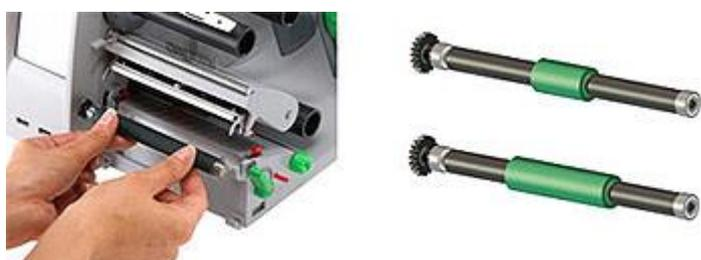
Pour le nettoyage ou le remplacement, le rouleau se démonte sans outils. Pour les étiquettes étroites il est possible que la tête d'impression frotte sur le rouleau, dans ce cas nous recommandons l'utilisation de rouleaux d'impression étroits de 25 ou 50 mm de largeur. Ceux-ci assurent une image d'impression de meilleure qualité et augmentent la durée de vie.
